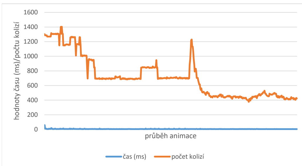
Obrázek 5.17: Tento graf zobrazuje čas výpočtu kolizí podle počtu kolizí algoritmu s vestavěnou funkcí.
